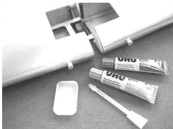
Tragflügelhälften mittels Aluminiumrohr zusammenstecken um Passgenauigkeit zu kontrollieren. Unter Zugabe von Klebstoff in den Papprohren und an den Wurzelrippen die Tragflügelhälften zusammenkleben.
