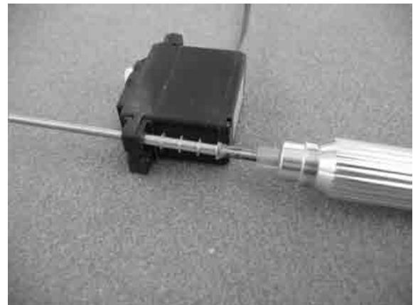
Wie auf den Fotos zu sehen die Ruderhörner in die Bohrungen der Ruder kleben und die Gestänge anfertigen. Hierzu die Gestänge entsprechend kürzen und gegenüber des M2 Gewindes eine M2,5 Gabelkopf auflöten.
