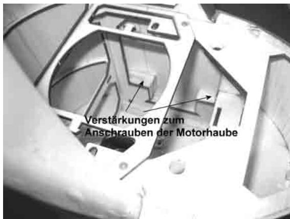
Positionen der Verstärkungen ausmessen und auf die Außenseite des Rumpfes bzw. der Motorhaube übertragen.
