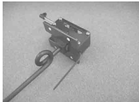
Dabei darauf achten, dass der Verriegelungsbolzen sich noch leicht, zum Verriegeln das Fahrwerks, verschieben lässt.
