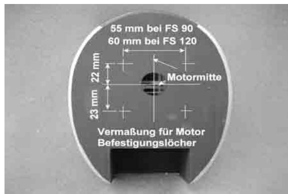
Entsprechend der Einschlagmuttern die Löcher in den Kopfspantring bohren.
