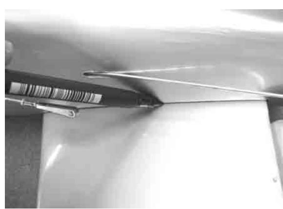
Etwas kleiner als angezeichnet, mit einem Lötkolben die Bespannfolie durchschmelzen und ablösen.
