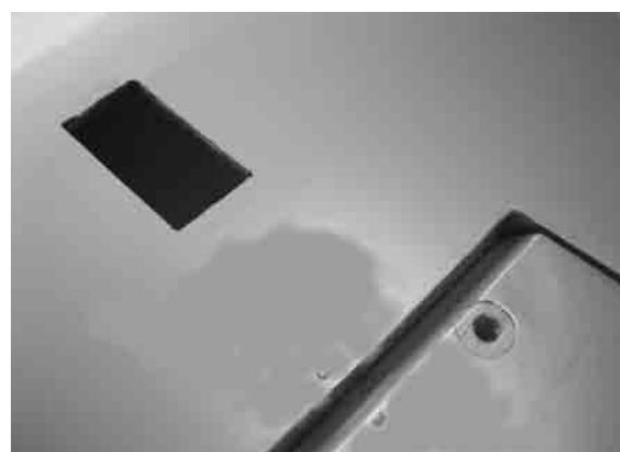
In Größe der Auflage der Ruderhörner die Bespannfolie von den Rudern ablösen. Gummitüllen und Messinghohlnieten in die Servoflansche stecken und die Servos mit den beiliegenden Schrauben in die Tragflächen schrauben.
