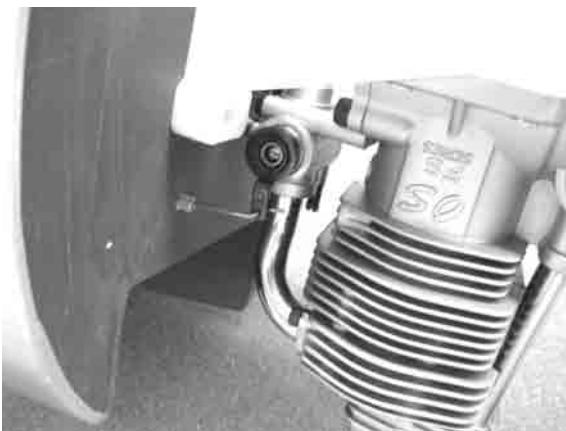
Drosselgestänge in Kunststoffröhren einschieben, so dass es in der Querbohrung des Gestängeanschlusses auf dem Servohebel des Drosselservos steckt. Bei Servo und Vergaser-Mittelstellung wird das Gestänge mit dem Gewindestift festgeklemmt. Wie auf dem Foto zu sehen den Schalldämpfer montieren.
