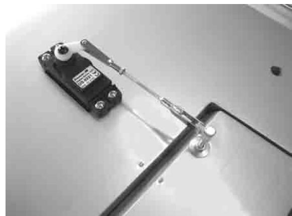
Bevor die Einziehfahrwerke eingebaut werden, müssen sie (Endstellungen) justiert werden
