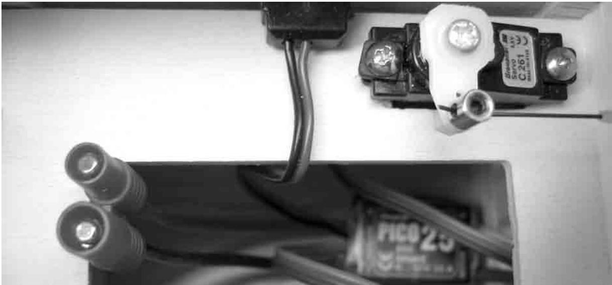
Den PICO 25 unterhalb des Akkuraumes platzieren. Den Ein/ Aus- Schalter, wie auf der Abbildung, an die linke Rumpfsseitenwand setzen. Seitenwand entsprechend aussparen, Schalter mit einem Tropfen Sekundenklebstoff sichern.
