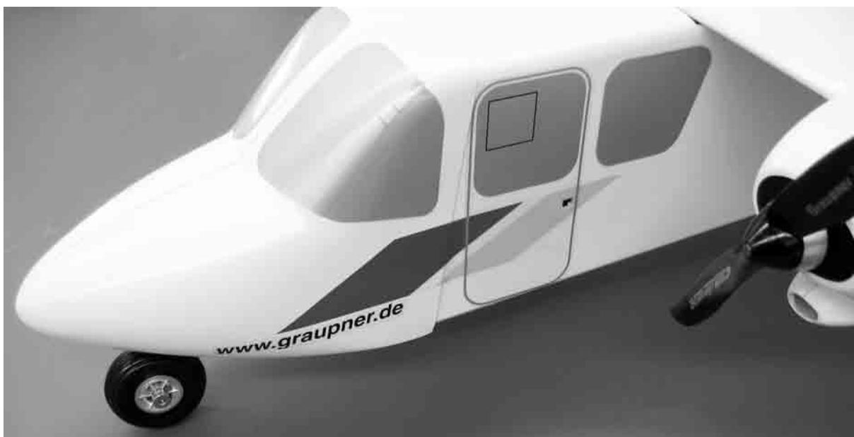
Les assemblages seront terminés avec la découpe et la pose des motifs de décoration. Noter que le motif du pare brise est composé de deux pièces afin qu'il puisse être collés le plus possible sans plis. Les nervurages sur les pantalons des jambes du train principal sont représentés avec un crayon feutre.
