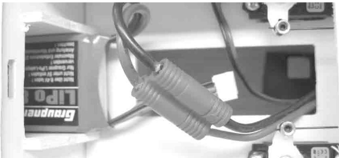
Die LiPo- Batterie ist in den Akkuschacht eingeschoben, Achtung, Vor dem schließen der G3,5 Steckverbindung den Regler ausschalten.
