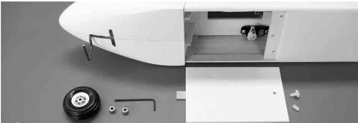
Das Bugrad mittels den Stellringen montieren, die Akkuschatzabdeckung mit der gekürzten M4 Schraube.
