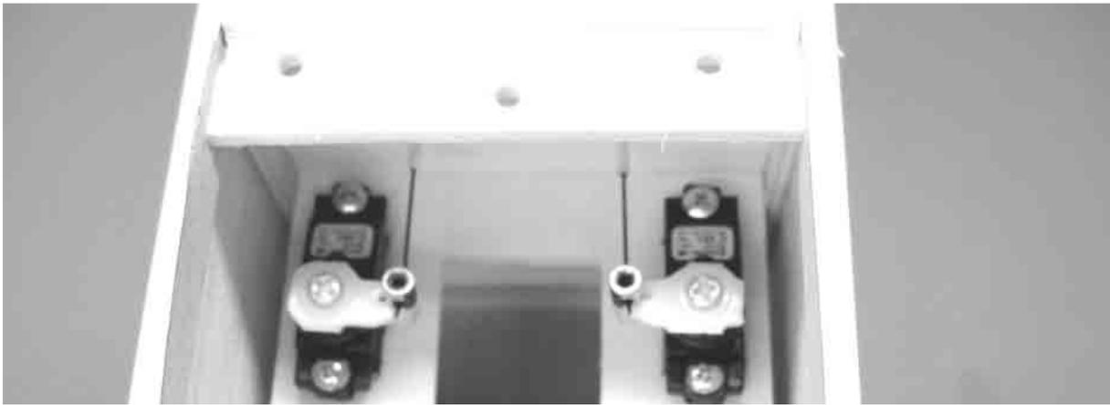
Die Servos sind eingeschraubt, die Ruderzüge gekürzt und eingeschoben. Zum Festziehen der M3 Stiftschraube den Gestängeanschluss mit der Flachzange festhalten. Darauf achten, dass die Ruder neutral stehen.
