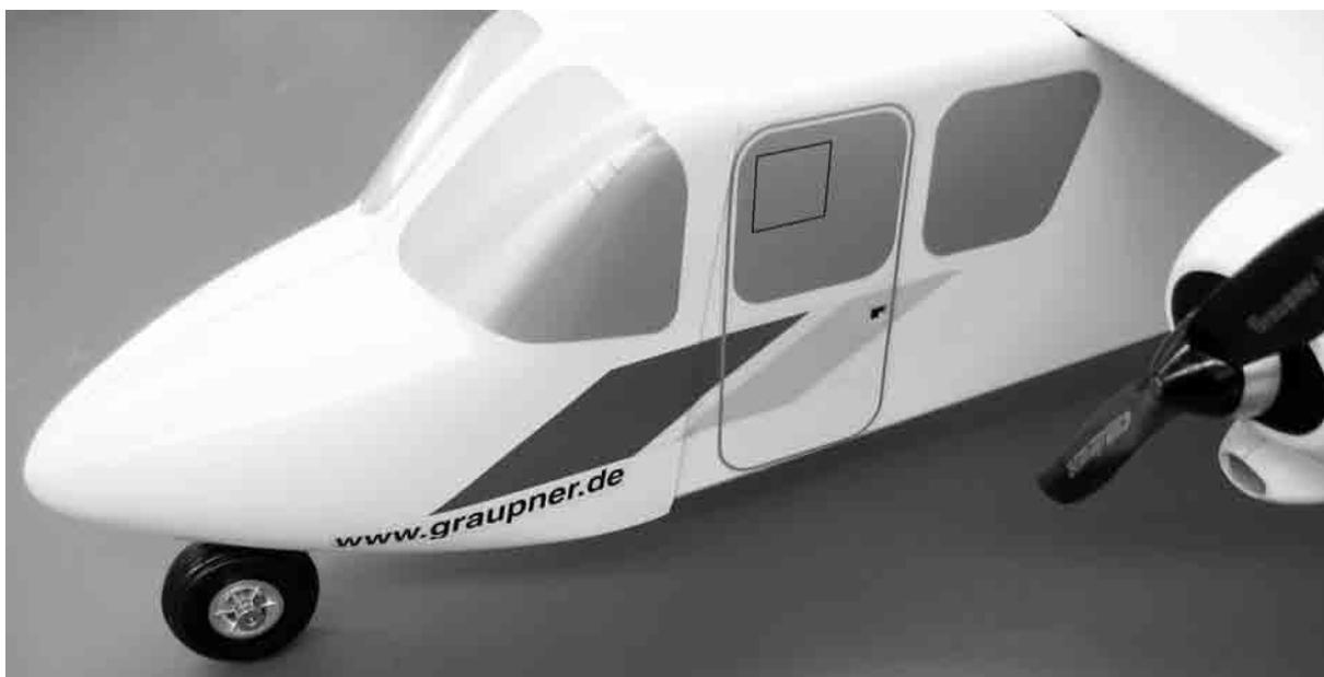
Der Zusammenbau wird mit dem Ausschneiden und Aufkleben der Dekorelemente abgeschlossen. Bitte beachten, dass die Frontscheiben 2- teilig ausgeführt sind, damit sie möglichst faltenfrei aufgeklebt werden können. Die angedeuteten Rippen auf den Strebenverkleidungen mit dem Faserstift aufzeichnen.
