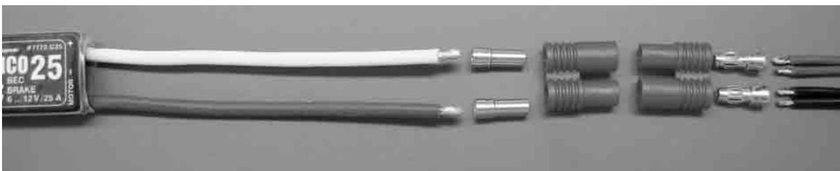
Die Abbildung zeigt die zum Anlöten vorbereiteten G 3,5 Goldstecker und Buchsen. **Achtung**, es darf kein Lötzinn an den Umfang der Goldkontakte kommen. Passiert dies trotzdem, dann mit einer Feile wieder abnehmen. Zum Eindrücken per Schraubendreher wird eine hohe Kraft benötigt. Vorsicht hier besteht Verletzungsgefahr.
