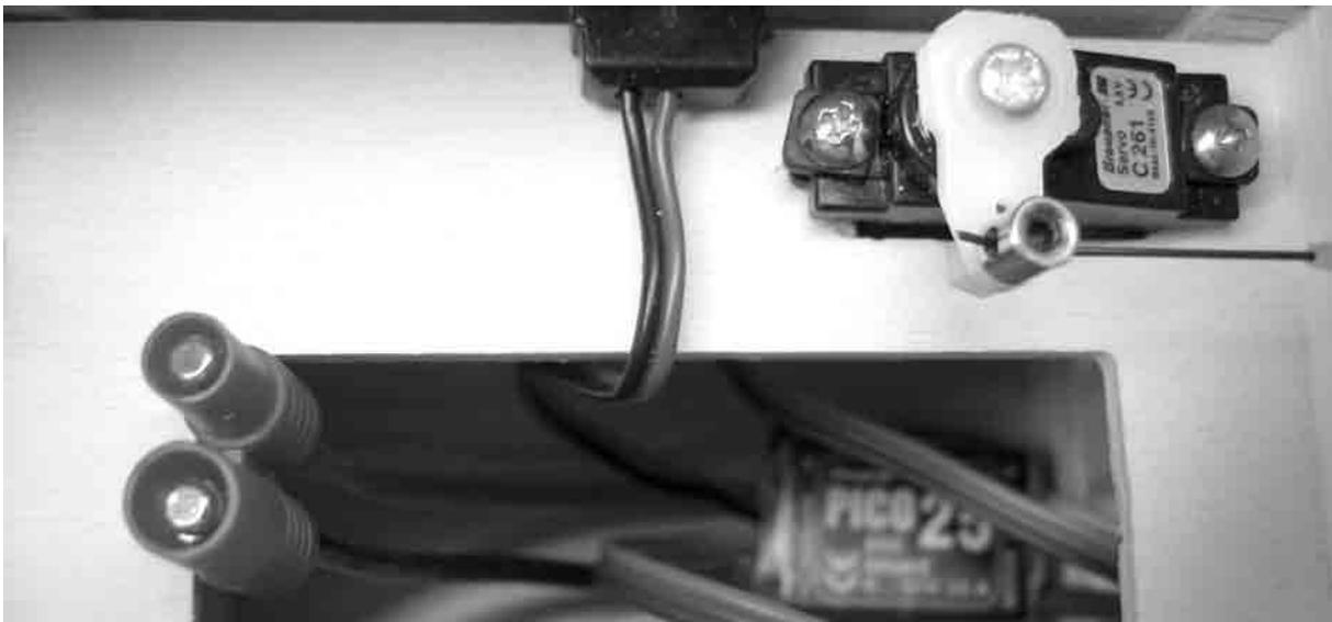
Placer le régulateur PICO 25 sous le logement de l'accu. Monter l'interrupteur de la réception sur le flanc gauche du fuselage, comme montré sur l'illustration ; percer le flanc en correspondance et coller l'interrupteur avec quelques gouttes de colle seconde.
