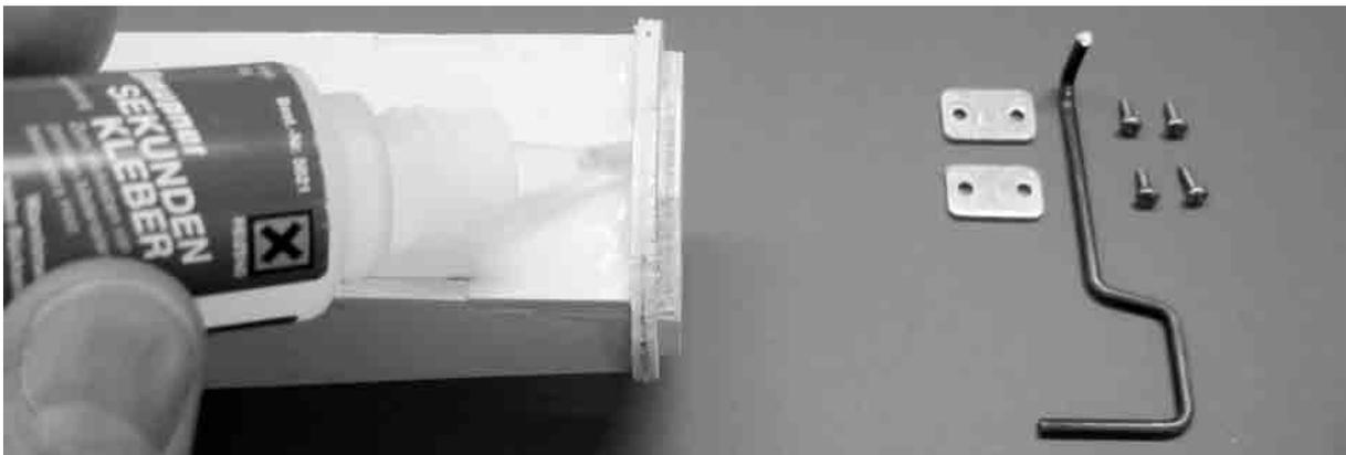
**Achtung**, zur Verstärkung in alle Ecken der Bugfahrwerksaufnahme Sekundenklebstoff fließen lassen. Den Bugfahrwerksbügel von vorne einschieben und mit zwei Stück Alulaschen, wie das Hauptfahrwerk, festschrauben, zusätzlich mit Sekundenklebstoff sichern.
