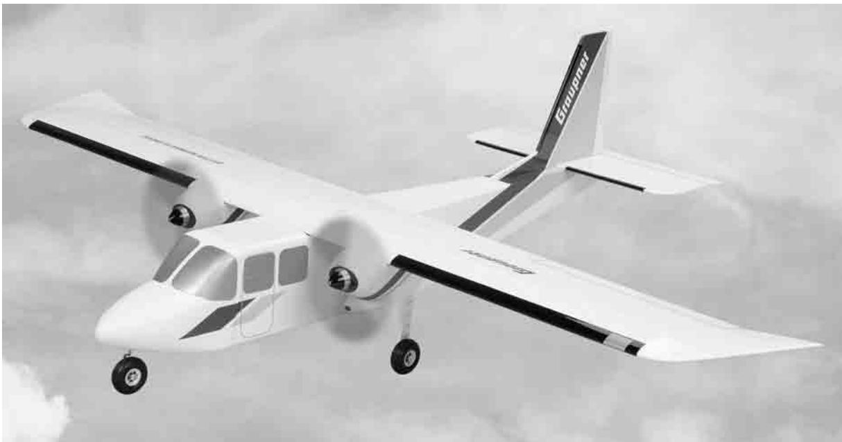
Für Elektroantrieb mit 2 oder 3 LiPo-Zellen
