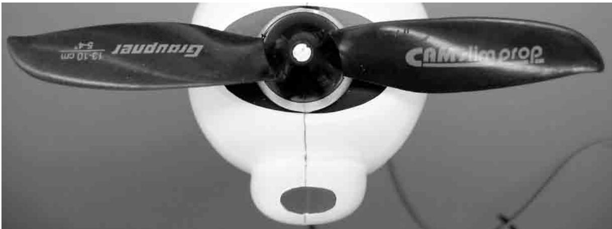
Evider la face frontale de l'entrée d'air inférieure et coller le motif de décoration ovale noir avec de fixer le moteur. **Attention** : Faire absolument un essai de fonctionnement avant de coller les nacelles sur l'aile. La consommation en courant sous 7,4 V est d'env. 4,1 A correspondant à 2 éléments LiPo. **Attention** : Si 3 éléments LiPo doivent être utilisés ultérieurement, monter de plus petites hélices, par ex. 1361.12.10.
