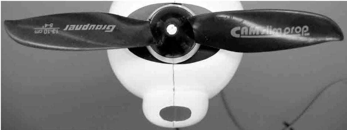
Die Frontfläche des unteren Kühllufteinlasses aussparen und das schwarze, ovale Dekorelement vor dem Einschrauben des Motors aufkleben. **Achtung**, unbedingt einen Probelauf durchführen, bevor die Gondeln auf die Tragfläche geklebt werden. Die Standstromaufnahme beträgt bei 7,4V, entsprechend 2 LiPo- Zellen ca. 4,1A . **Achtung**, sollen später 3 LiPo- Zellen eingesetzt werden, eine kleinere Luftschraube z.B.1361.12.10 verwenden.
