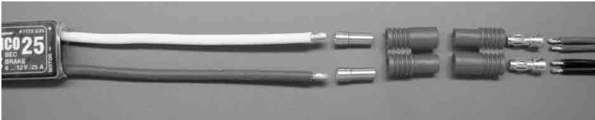
L'illustration montre les connecteurs Gold G 3,5 mâle et femelle préparés pour la soudure. **Attention** : Aucune soudure ne doit pénétrer sur les contacts dorés ; si cela arrive toutefois, la retirer ensuite avec une lime. Une bonne force est nécessaire pour les connecter par tournevis, agir ici avec précaution !
