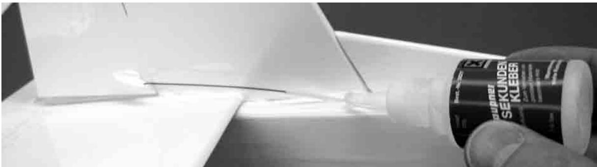
Höhen- und Seitenruder mit Bohrung  $\varnothing$  3,0mm versehen, die Ruderhörner in die Züge einhängen, und einkleben. Abschließend noch das Führungsrohr des Seitenruderzuges mit dem Rumpf verkleben.
