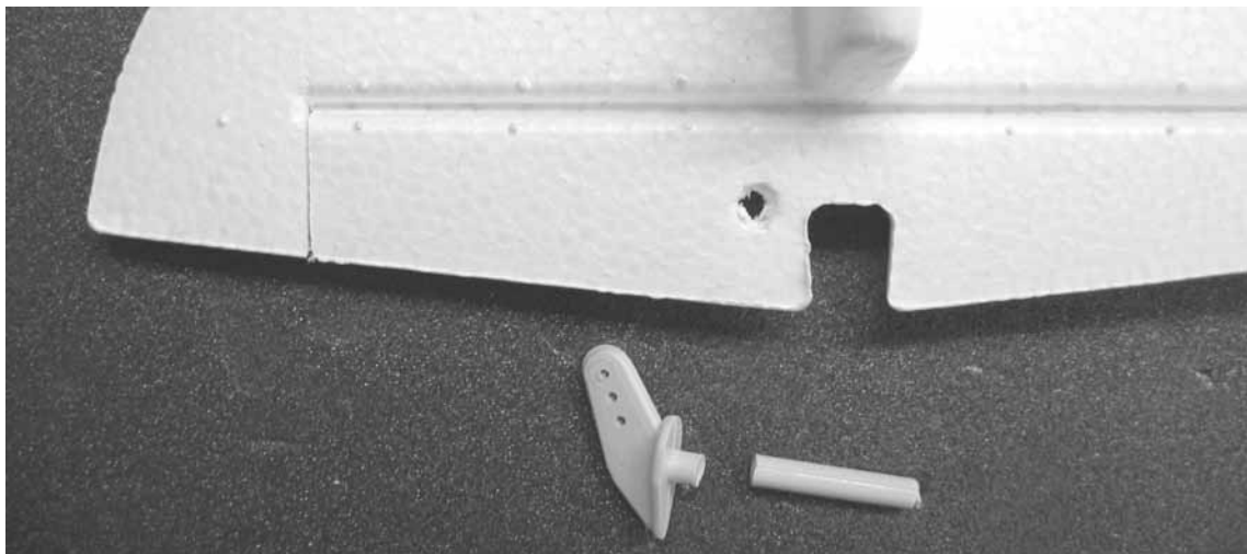
Abb. Nr. 9 Das Ruderhorn (6) kürzen und gemäß Abbildung einpassen, jedoch noch nicht einkleben.
