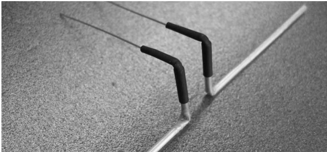
Abb. Nr. 12 Die Hebelgelenke (10), bestehend aus Schrumpfschlauch werden per Heißluftföhn in Gebrauchslage eingeschrumpft. In der Rumpfseitenwand die Öffnungen für die Querruderhebel aussparen und die Anlenkungen probeweise einsetzen.
