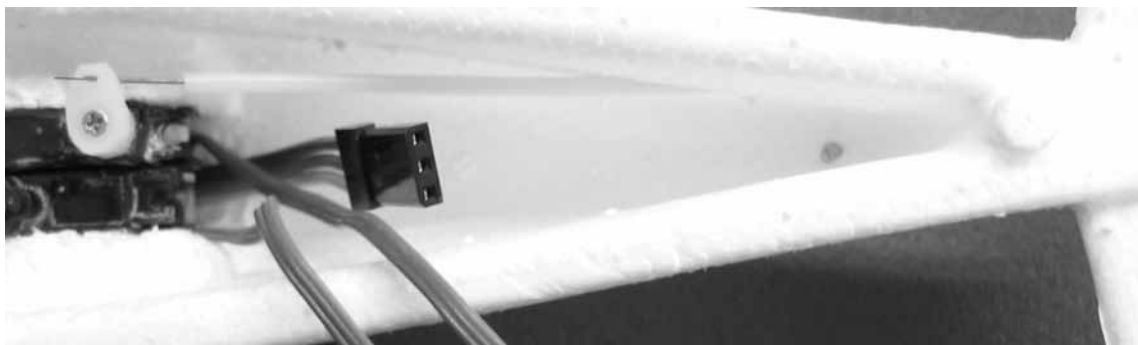
Abb. Nr. 10 Die Abbildung zeigt die probeweise eingeschobenen Servos C 100. Der Servohebel des Höhenruderservos ist gekürzt (Hebellänge 5mm) und das Servo neutral eingestellt. Vor dem Aufschrauben des Servohebels den Höhenruderzug (7) einhängen. Den Zug (7) hinten passend abkröpfen und kürzen. Erst, wenn alles passt, die Teile (5) und (6) einkleben. Achtung, dass kein Klebstoff in den Bowdenzug gelangt. Das Anschlusskabel des Querruderservos, sowie das Verlängerungskabel unter den Servos nach hinten führen.
