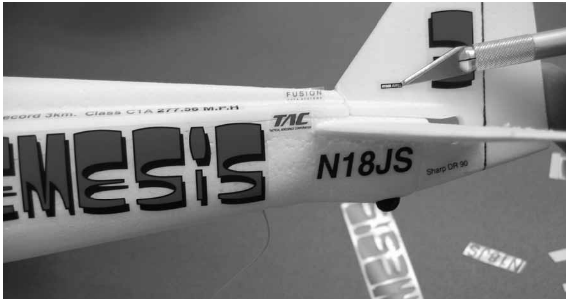
Abb. Nr. 24 Das komplette Modell nun vorsichtig überschleifen, den Schleifstaub entfernen. Die einzelnen Dekorelemente ausschneiden und aufkleben. Die Ruder mit schwarzen Linien hervorheben.
