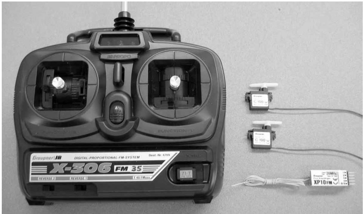
Abb. Nr. 1 X-306 FM 35 mit 2 zusätzlichen Servos C 100 und Empfänger XP 10FM
